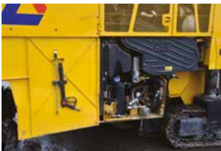
Wateraansluiting voor de watertank en de hydraulisch aangedreven hogedrukreiniger.
