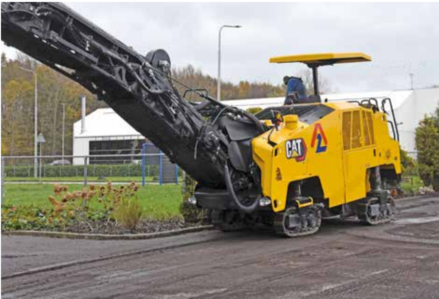
De afvoerband is hydraulisch inklapbaar en 60° naar links of rechts verstelbaar.
